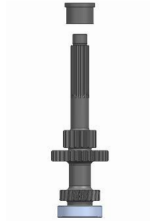
b. Insert the spacer.
