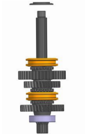
j. Insert the spacer.
